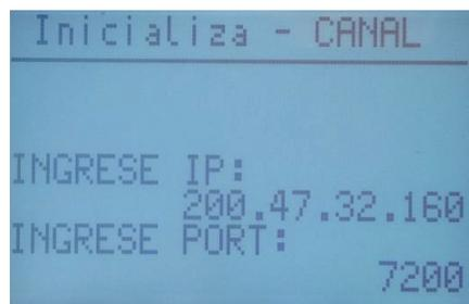
6. El sistema le mostrará en pantalla el puerto y la IP que se encuentran configurados. Presionar ENTER (**no modificar datos**).
