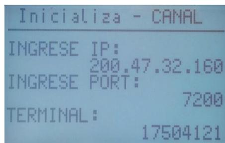
7. El sistema le mostrará en pantalla el puerto, la IP, y la terminal que se encuentran configurados. Presionar ENTER **(no modificar datos)**.
